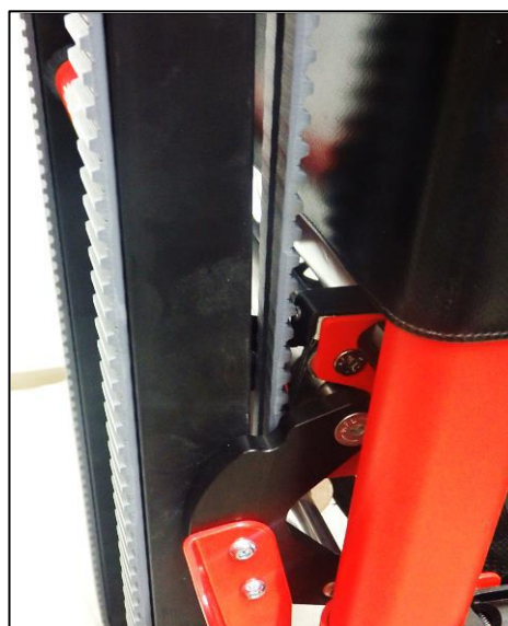
Skinne fastgjort til stoleryggen via skub-til-luk låsene
